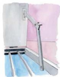
Système de maintien d'ouverture de la trappe par compas.
